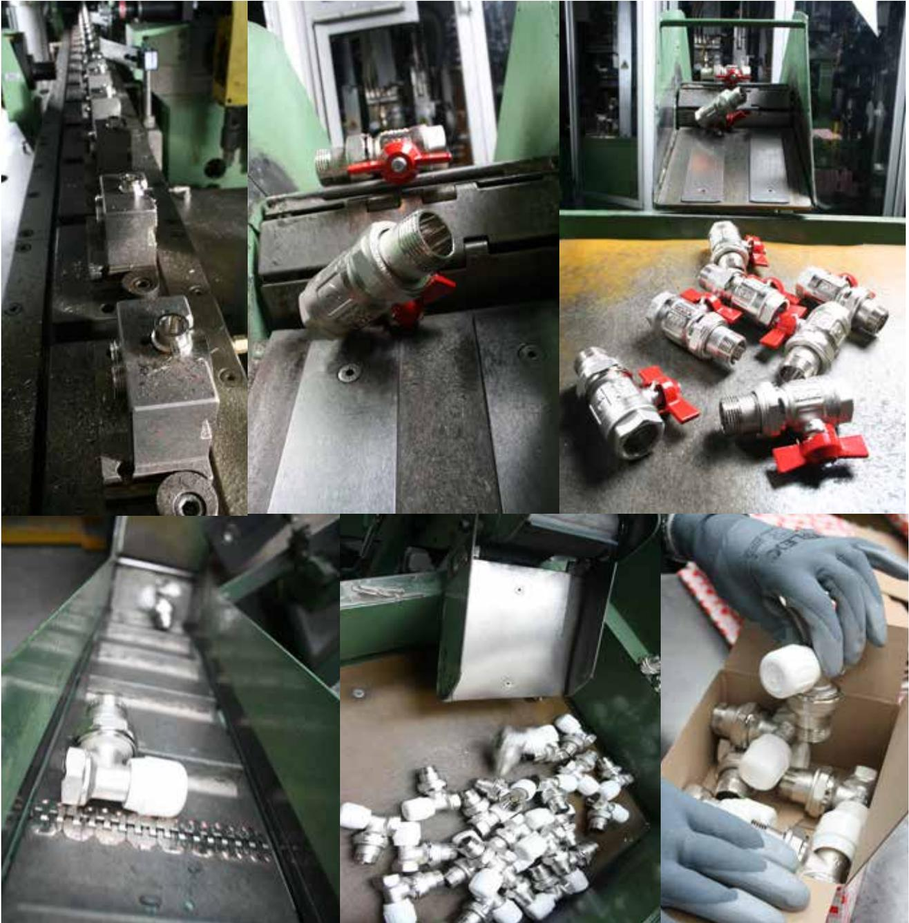
В компании ИТАР имеется 51 технологическая линия по сборке и испытанию арматуры. На них ежедневно собираются и полностью испытываются приблизительно 200 тыс. клапанов, отправляемых далее на склад и потребителям.
