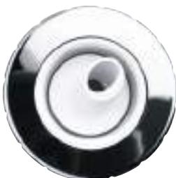
Гидрофорсунки подают смесь воды и воздуха. В результате подачи смеси происходит сильное массажное воздействие. Гидрофорсунки Maxi ротационные имеют хромированный фасад диаметром 90 мм. Силу воздействия водной струи можно настроить вращением внутренней части форсунки. В ротационной форсунке сила потока воды создает дополнительное вращение сопла, что увеличивает массажный эффект. Эти форсунки используются в ваннах Thermae.
