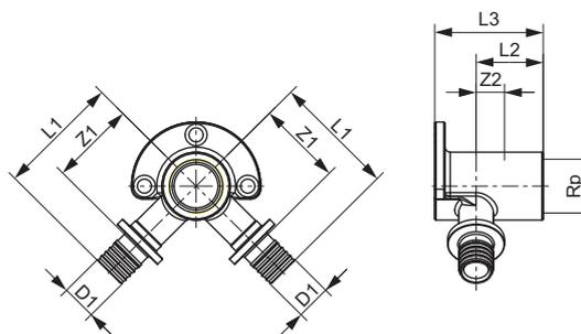
Тройник угловой с настенным креплением TECEflex, закругленный, с низким падением давления, бронза/кремнистая бронза
