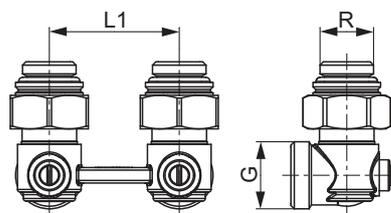
Монтажный набор TECEflex для подключения радиаторов к плинтусной разводке
