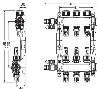
**Модуль подключения пластикового коллектора TECEfloor**
