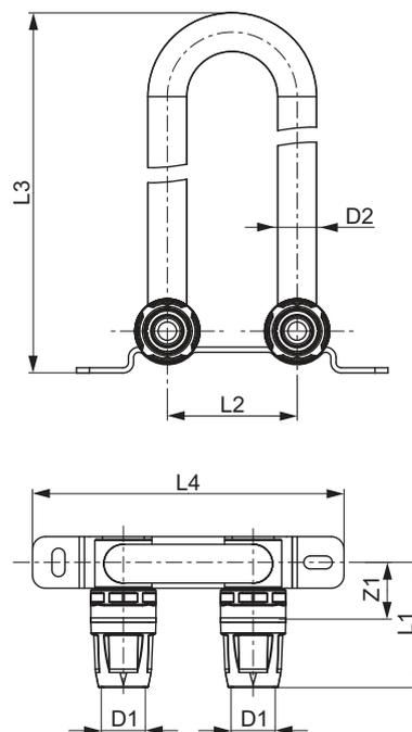
Монтажный узел TECElogo для подключения радиаторов
