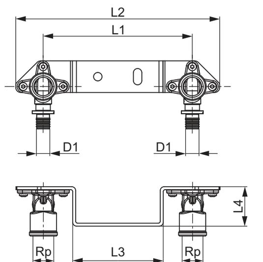
Монтажная пластина TECE из оцинкованной стали для настенного уголка
