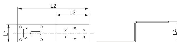
Монтажная пластина TECE из оцинкованной стали для двух настенных уголков
